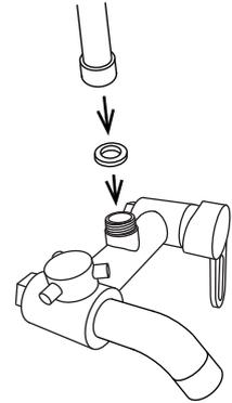
**6** Установите основную часть настенного крепления на штанге тропического душа.
