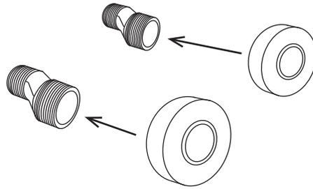
**2** Прикрутите корпус смесителя к эксцентрикам, используя инструменты, щадящие хромированную поверхность.
