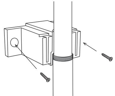
**9** Прижмите наружную часть крепления к верхней штанге тропического душа, чтобы направляющие на обеих частях настенного крепления совпали, и сдвиньте наружную часть вниз до упора. Закрутите шпильку.
