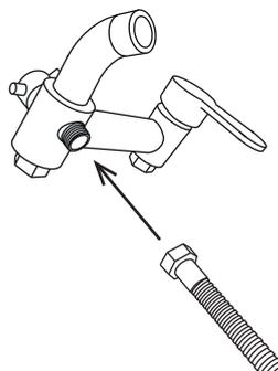
**14** Включите систему водоснабжения. Проверьте герметичность соединений при закрытом положении рукоятки смесителя.
