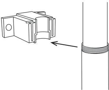
**7** Углубления в настенном креплении должны соответствовать диаметру штанг. Отметьте точки для сверления, снимите крепление и просверлите отверстия.
