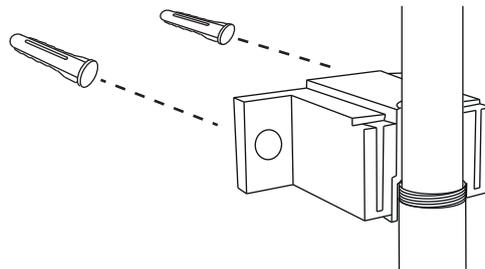
**8** После сверления снова установите основную часть настенного крепления в то же положение и прикрепите его саморезами к стене.
